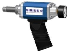
3. Durch Betätigen des Spannhebels wird Luft in das Rohr geblasen, bis der Prüfdruck erreicht ist.
